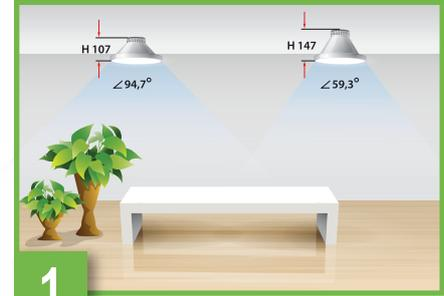
**1** Доступен в версиях с разными рефлекторами – обеспечивает углы освещения 94,7° (Largo LED 20) и 59,3° (Largo LED 20 DEEP).
